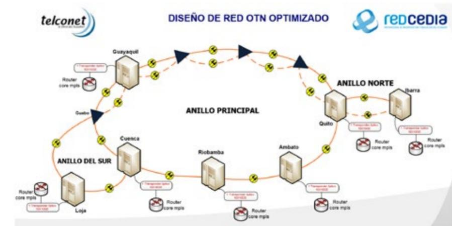
Figura 45: Diseño de la Red de transporte óptico con capacidad de 100 Gbps
